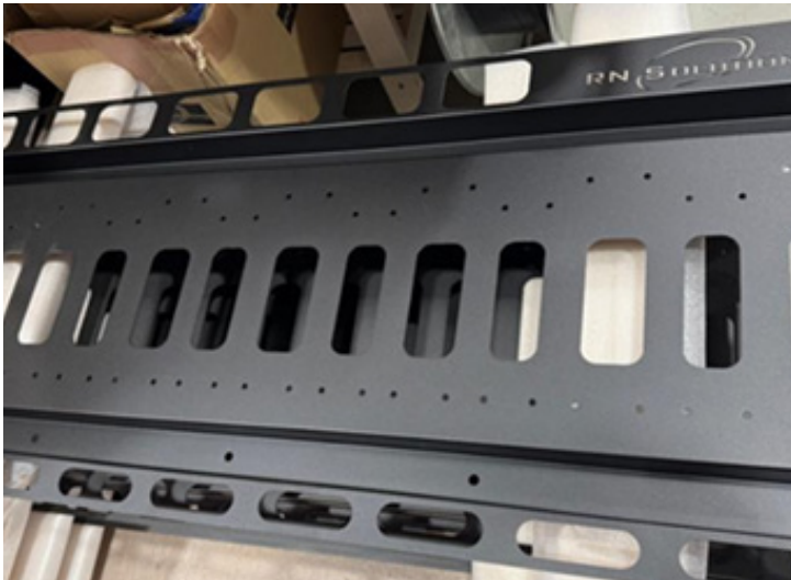
Fertige Montageplatte für MeanWell-Treiber.
