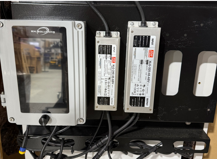
MeanWell-Treiber werden komplett als 100 % Plug 'N Play geliefert – benötigen nur 1 × 13-A-CCE-Stecker pro Treiberset.
