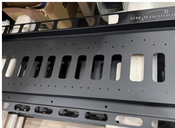
Færdig monteringsplade til MeanWell-drivere.
