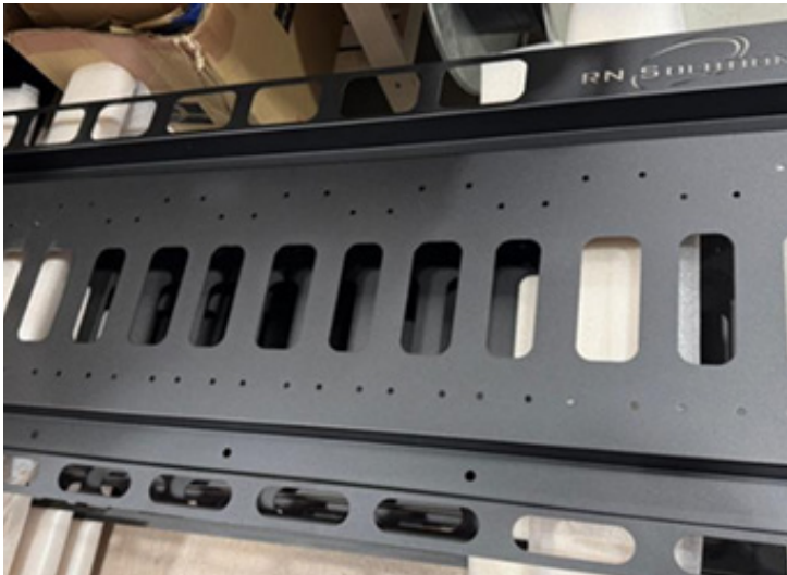
Placa de montaje terminada para drivers MeanWell.
