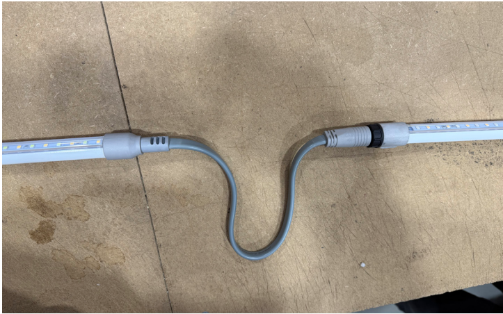
Cable de interconexión plano, 3 × 2,5 mm 2 .
