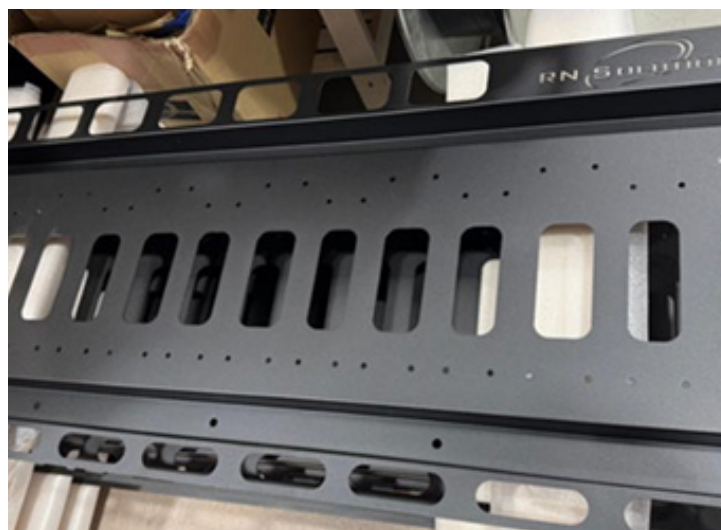
Färdig monteringsplatta för MeanWell-drivdon.
